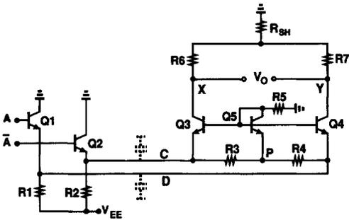
Fig. 8. Buffer/level shifter.
