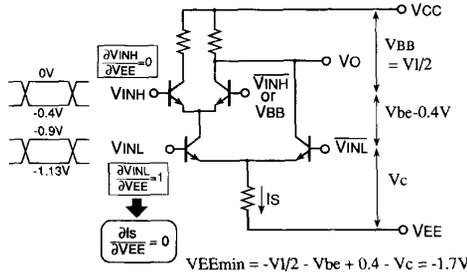
Fig. 2. Low-voltage Series-Gate (LSG).
