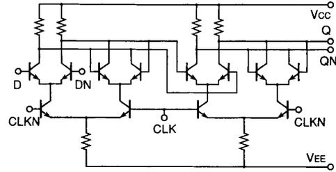
Fig. 5. LSG flip-flop.
