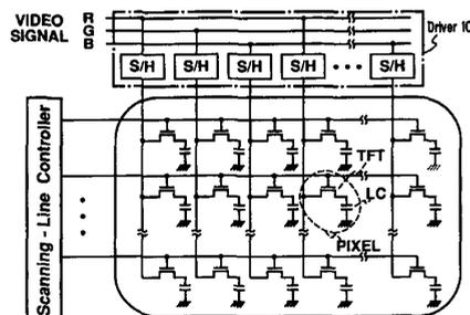
Fig. 1. TFT-LCD module.
