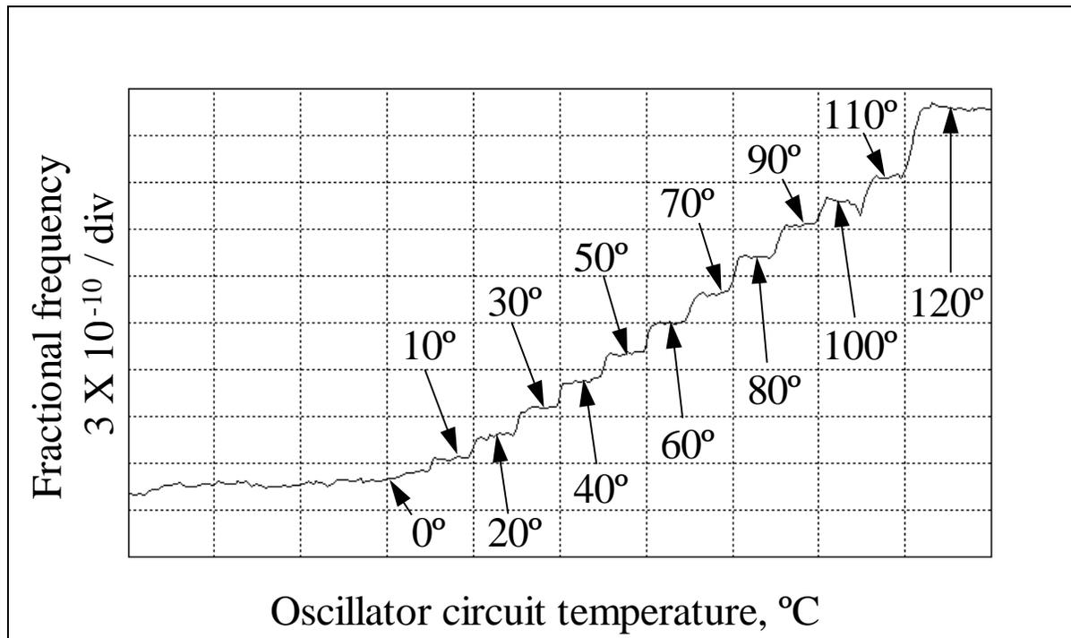
Figure 20. Oscillator circuit tempco (less crystal).
