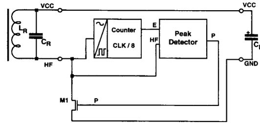
Fig. 7. Transponder oscillator.
