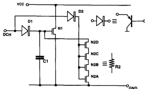
Fig. 10. Discharge circuit.
